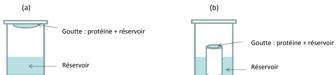
Figure 80: Technique de cristallisation par diffusion en phase vapeur : (a) goutte suspendue ou (b) assise
