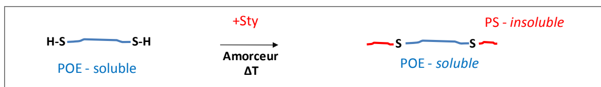
Figure 9 – Formation de copolymères à blocs à partir d'un macroagent de transfert.
