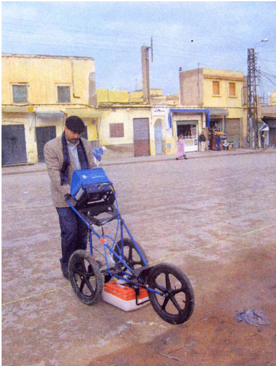
Figure 4.4.2.2 : Acquisition radar sur le terrain, antenne 400 MHz
