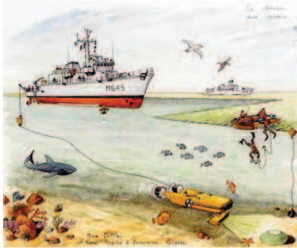
FIGURE 1.10 – Scénario actuel de guerre des mines [35]. Une mine est présente en bas à droite de l'image. Le bateau représente le CMT qui détecte la mine, le ROV la classifie et le plongeur la désarme.
