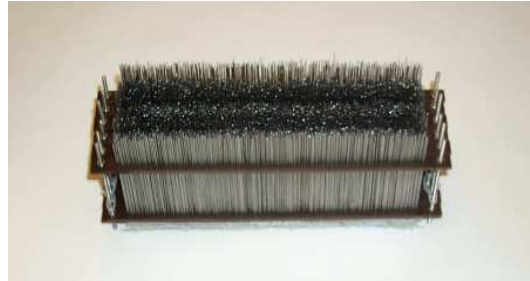
FIG. I.13: Echantillon 2D de tiges en acier réparties aléatoirement. Ces milieux sont classiquement utilisés au laboratoire pour étudier les phénomènes physiques mettant en jeu la diffusion multiple.
