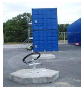
Figure IV. 11 A gauche : Deux radiomètres installés sur le toit des containers pour mesurer le flux global incident et le flux infrarouge en provenance du ciel. A droite : Un pyranomètre dédié à la mesure du rayonnement solaire diffus installé sur le sol au voisinage de la maquette.
