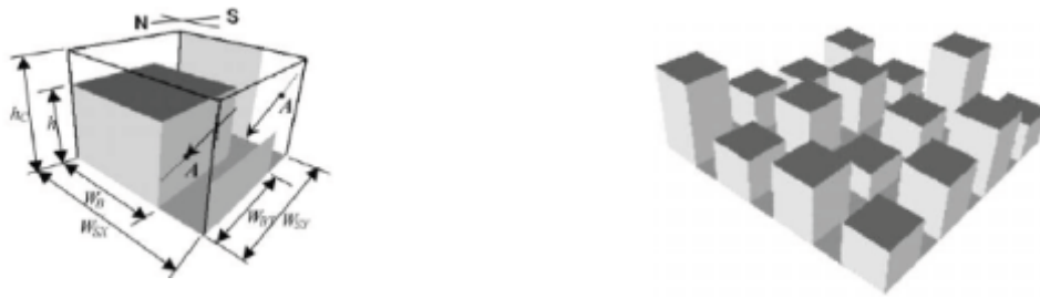
Figure I. 13 A gauche : le modèle de bâtiment en forme de carré utilisé pour l'étude numérique. A droite : la seconde configuration d'étude présentant des hauteurs différenciées (Kondo et al. , 2001).
