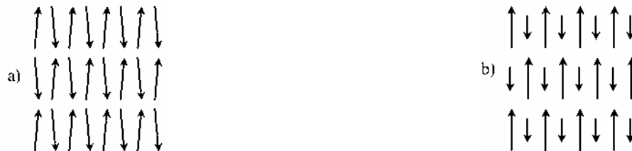
Figure 4 : Représentation schématique de phases a) ferromagnétique faible et b) ferrimagnétique à deux sous réseaux.
