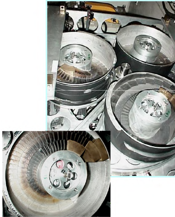
Figure II.3- Système de modulateurs IBA. En haut à droite : la grande roue portant trois roues plus petites. En bas à gauche : zoom sur une roue qui porte trois pistes formées chacune de secteurs de différentes épaisseurs. Chaque piste constitue un modulateur.
