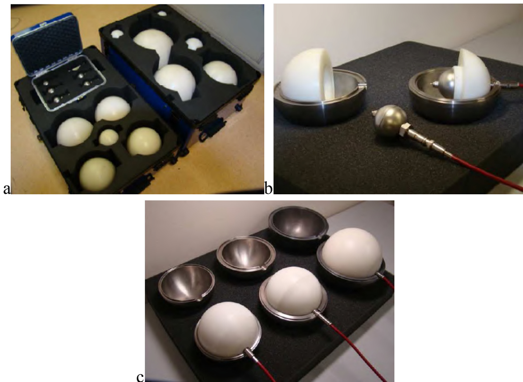
Figure IV.1- Spectromètre HERMEIS : a) l'ensemble des sphères de Bonner constituant le système, b) une sphère de mesure des neutrons de hautes énergies grâce à la couche de tungstène qui apparaît sur la figure ; le détecteur central des neutrons thermiques apparaît aussi sur cette figure, c) l'ensemble des trois sphères destinées aux hautes énergies.
