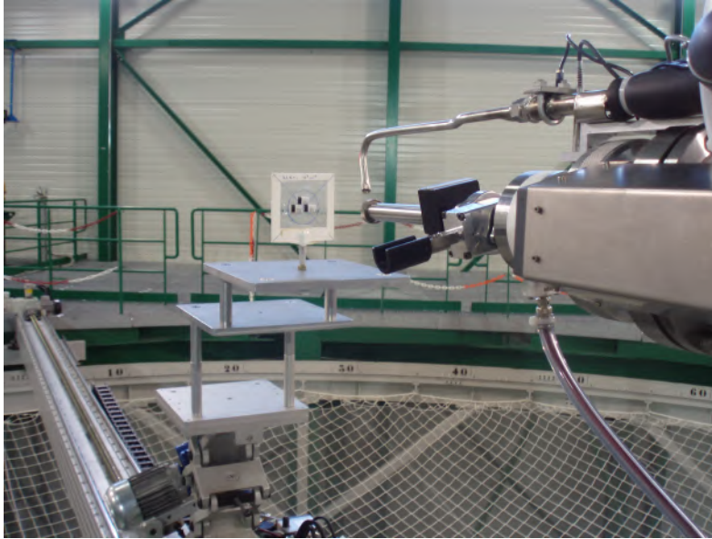
Figure E 5- Irradiations des CR-39 aux basses énergies auprès de l'installation Amande. Le support des détecteurs, la plaque en plexiglas et les CR-39 apparaissent sur la figure.
