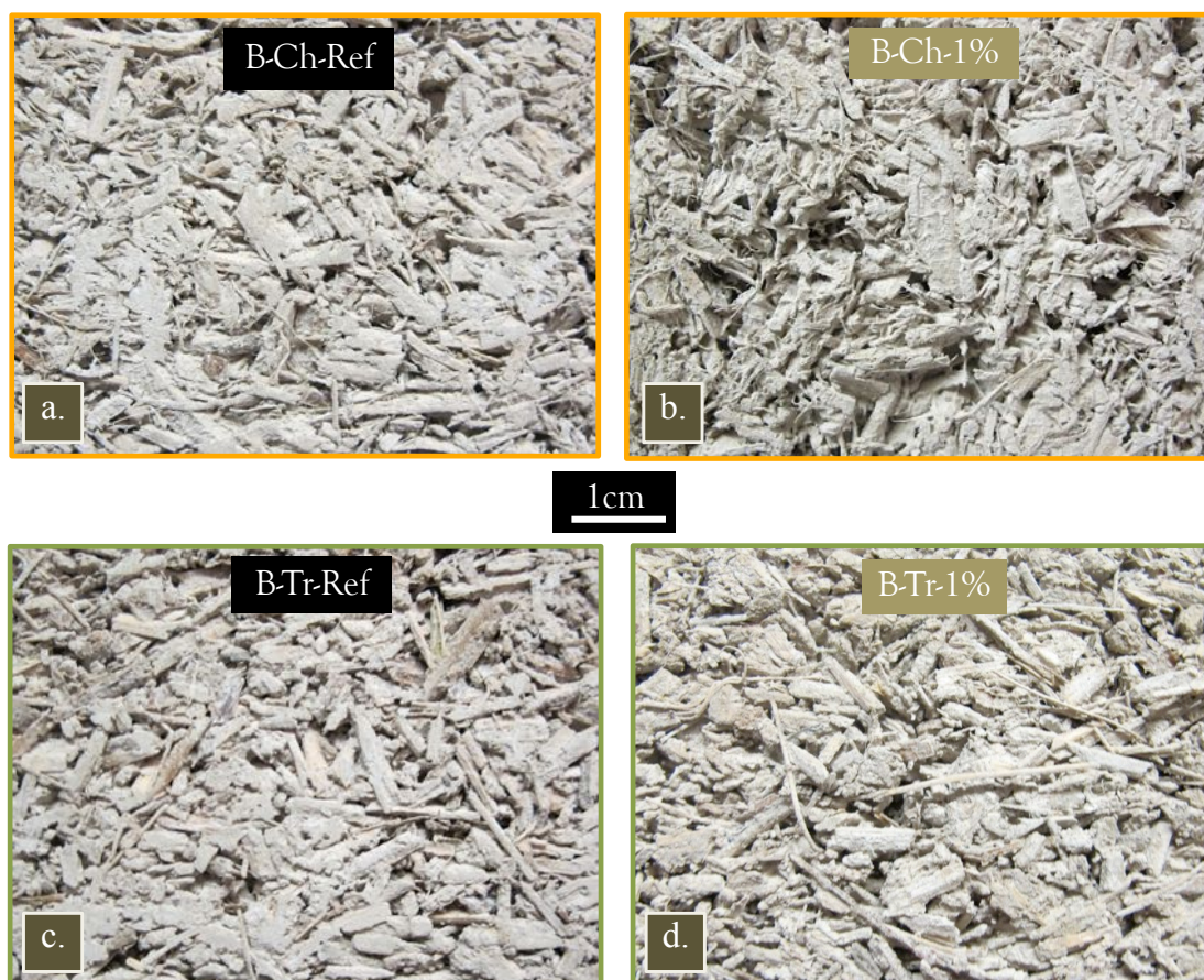
Figure III. 60. Photographies de la surface des bétons de chanvre (B-Ch-Ref (a) et B-Ch-1%
