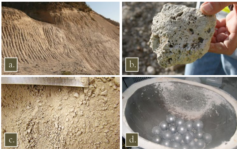
Figure II. 17. Photos de la ponce trachytique et du dispositif de transformation. Carrière du cheix (a), gros élément de ponce trachytique présent dans le sable (b), sable de ponce brut (c) et broyeur à boulet (d).
