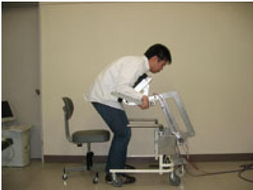
FIG. 1.8 – Robot verticalisateur de réadaptation fonctionnelle de l'Université d'Electro-Communications des systèmes d'information de Tokyo.
