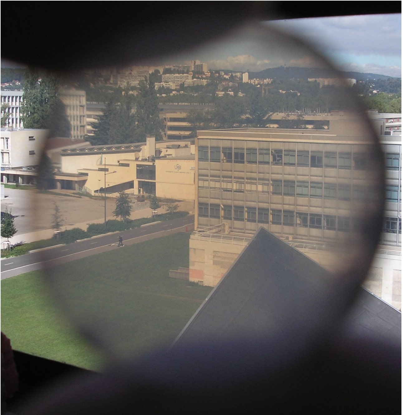
Figure 3.13: Echantillon FP fritté par SPS à T_f = 1130^\circ\text{C} (épaisseur réelle = 1,4 mm, \text{RIT}_{640\text{nm}} = 52\% pour une épaisseur de 0,88 mm, \phi_G = 0,48 \pm 0,15 \mu\text{m} )
