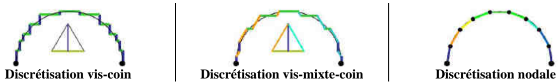
Figure 120 – Différentes représentations d'une ligne de dislocation discrétisée en segments.
