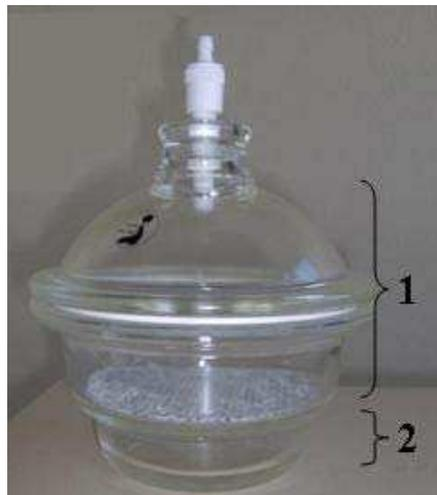
Figure IV.9 : Dessiccateur utilisé pour le stockage des PU
