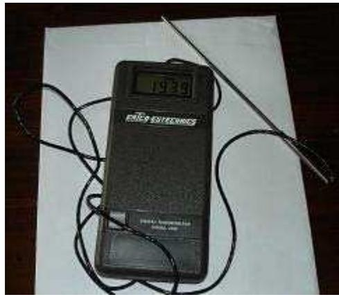
Figure VI.1 : Thermomètre (ERTCO-EUTECHNICS, MODEL 4400)
