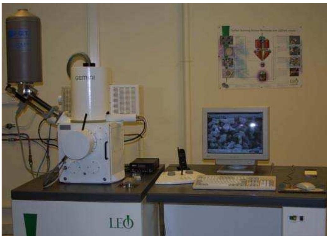
*Figure IV.14 : Vue générale de l'Appareil MEB LEO 1530*
