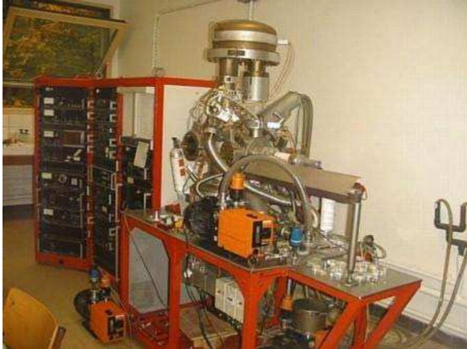
Figure IV.17 : Vue générale de l'Appareil ESCA LEYBOLD LHS10
