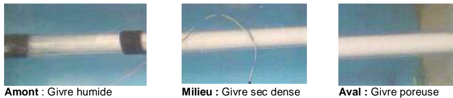
Figure 121 : Apparence du givre humide
