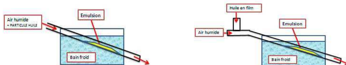
(A) Huile introduite sous forme de particules
