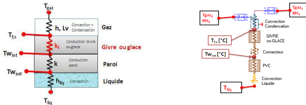
Figure 225 : Modélisation de 1D en présence de couche de givre ou de glace
