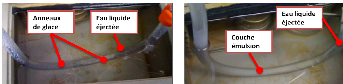
(A) Essai avec air humide pur (B) Essai avec film d'huile pré-refroidi Figure 92 : Impact de l'huile sur la cristallisation (Essai préliminaire)
