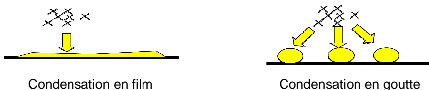
Figure 48 : Phénomènes de condensation
