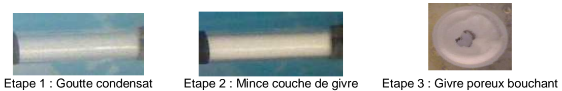
Figure 113 : Processus formation givre
