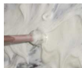
Figure 50 : Émulsion obtenue par huile atomisée et condensation de l'air humide (CERTAM/ENSCP)
