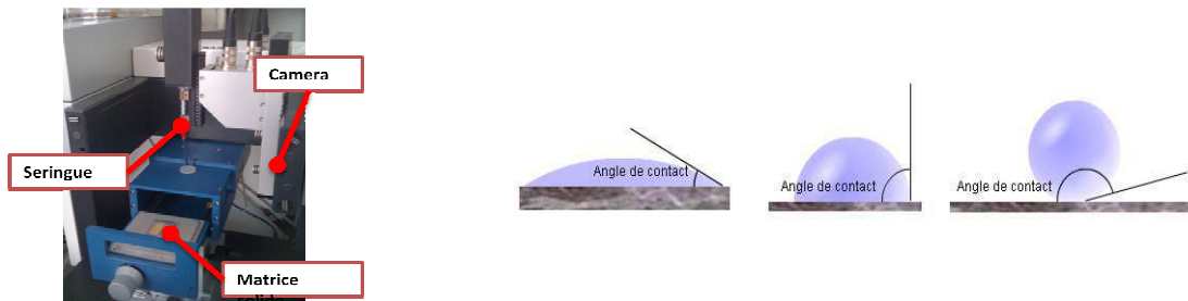
Figure 71 : Méthode de mesure de l'angle de contact (Essai en laboratoire)
