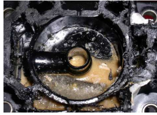
Figure 3 : Émulsion de blow-by
