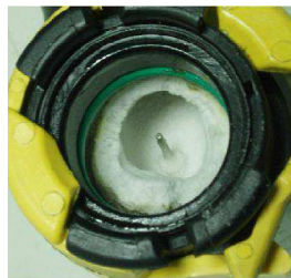
Fig A. 1 : Exemple de givre dans un circuit de blow-by
