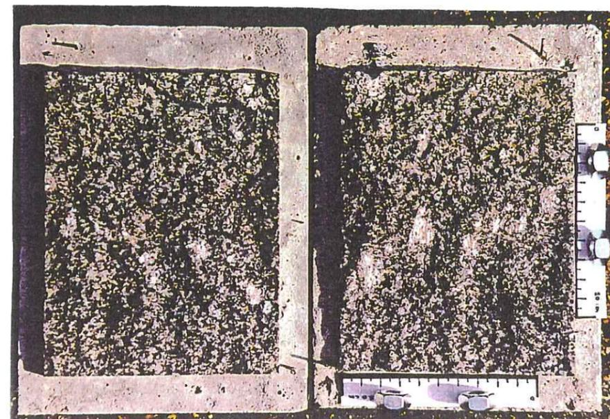
Figure 5.15 : Description des épontes inférieure (à droite) et supérieure de l'échantillon 3 après l'essai.
