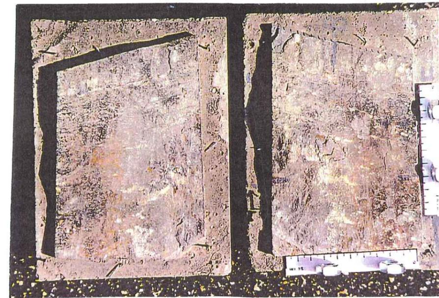
Figure 5.13 : Description des épontes inférieure (à droite) et supérieure de l'échantillon 1 après l'essai.
