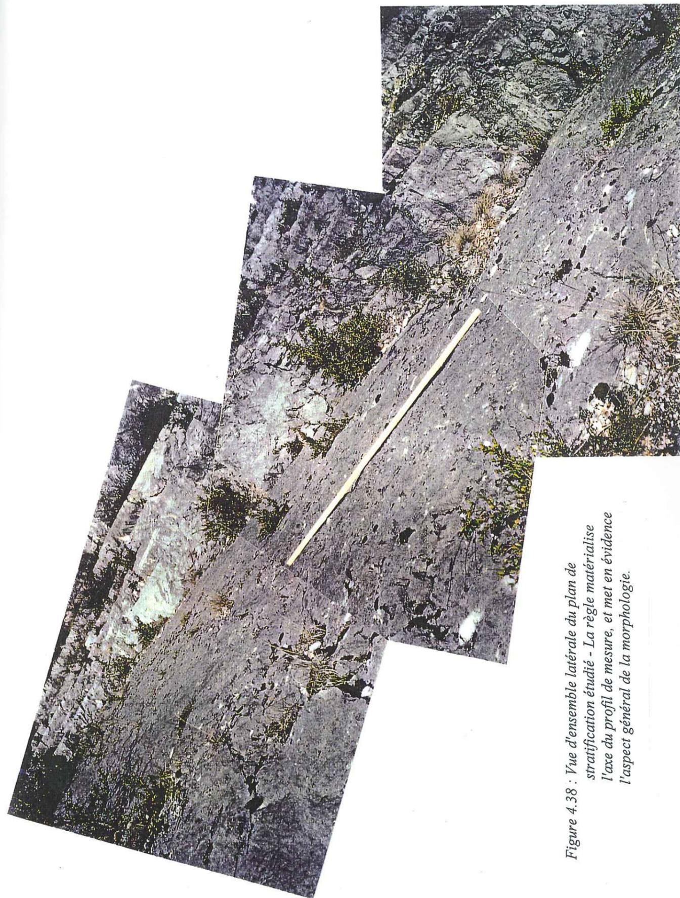
Figure 4.38 : Vue d'ensemble latérale du plan de stratification étudié - La règle matérialise l'axe du profil de mesure, et met en évidence l'aspect général de la morphologie.
