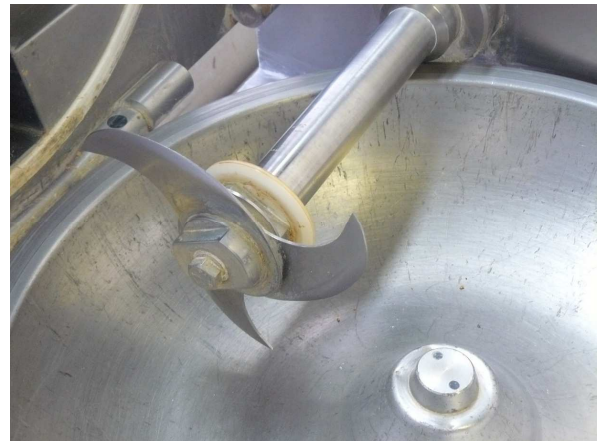
Figure 61 Vue d'ensemble du malaxeur (a) et détails de l'arbre et des couteaux (b)
