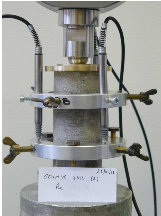
Figure 71 Dispositif de mesure locale de déplacement
