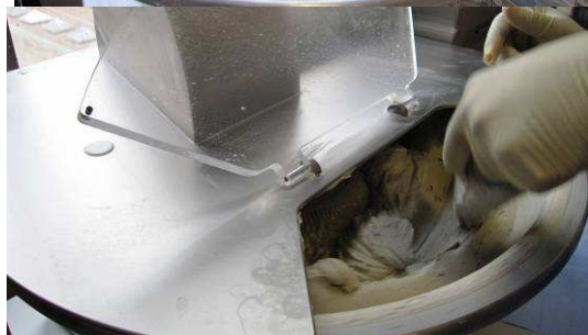
Figure 63 Les différentes phases du malaxage : mise en place du mélange sol-ciment sec (a), temps de repos après ajout de l'eau (b) et malaxage avec aide de l'opérateur (c)
