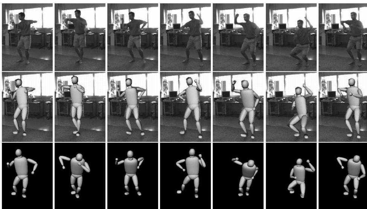
FIG. 1.30: Sminchisescu et Triggs [ST01][ST03] : suivi monoculaire en 3D. Les améliorations sur le rééchantillonnage du filtre à particules permet d'offrir un environnement peu contraint mais la robustesse reste insuffisante.
