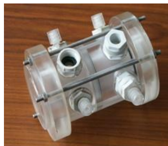
Figure IV- 1 : Photo de la cellule de dialyse ionique croisée utilisée.
