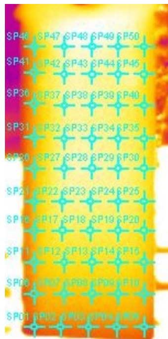
Figure II.7 : Essais de mesure du champ de température de la surface arrière de la plaque
