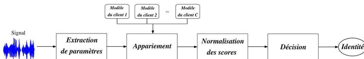
FIG. 2.1: Architecture d'un système d'identification du locuteur.
