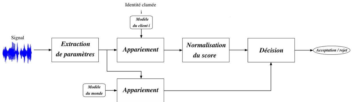
FIG. 2.2: Architecture d'un système de vérification du locuteur.
