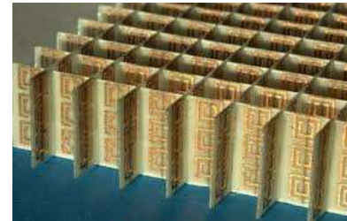
Figure 1.5. Premier métamatériau réalisé avec une succession périodique de fils et boucles ouvertes de cuivre 16
