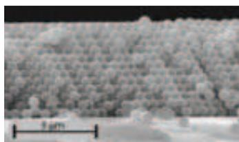
Figure 41 : Cristal de particules de SiO<sub>2</sub> obtenu par spin-coating<sup>49</sup>
