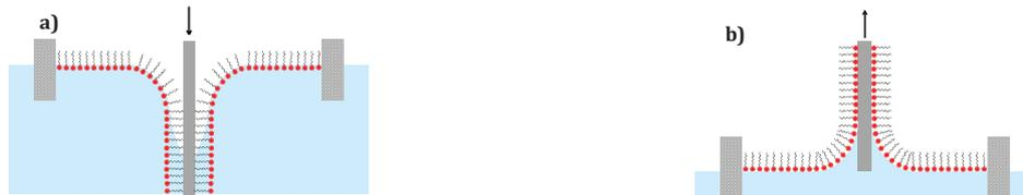
Figure 45 : Schéma de transfert par a) immersion de substrat \_ b) émersion de substrat
