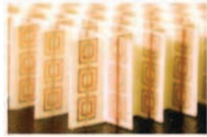
Figure 4 : Photographie du premier métamatériau à indice de réfraction négatif<sup>6</sup>
