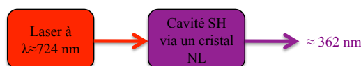
FIGURE 3.1 – Principe de réalisation de la source laser pour le piège dipolaire à partir d'un laser dans la gamme de radiation de 724 nm suivi par un processus non-linéaire (NL) via un cristal pour la réalisation du second harmonique (SH).
