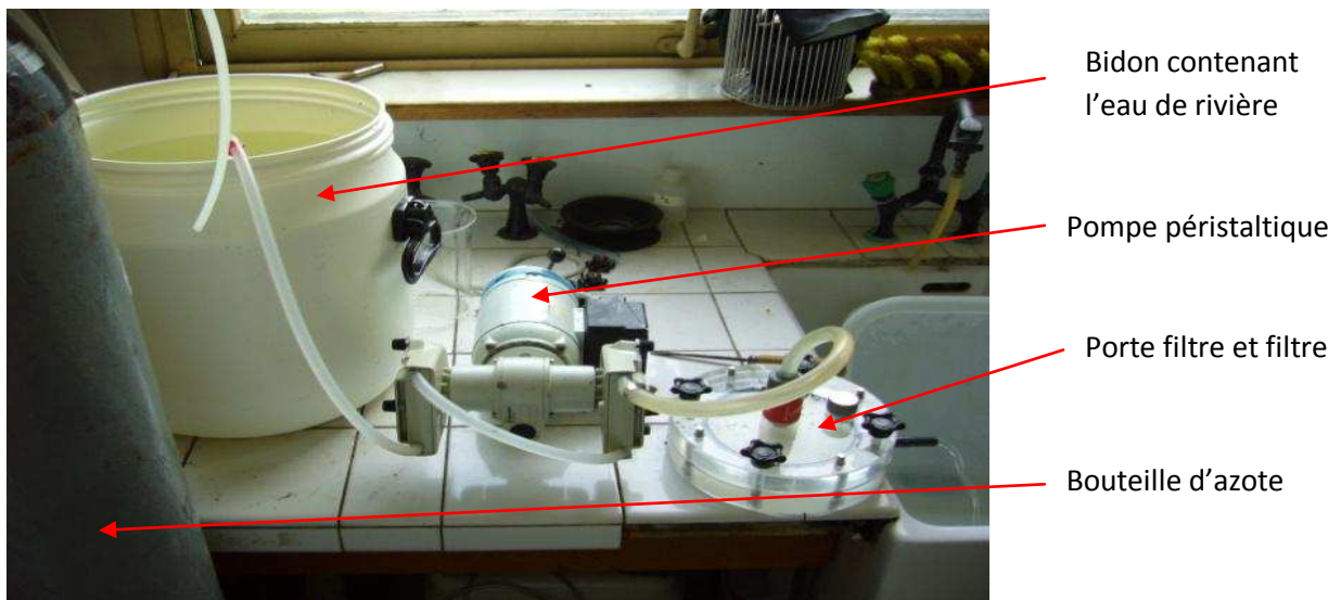
Figure 15. Dispositif utilisé pour filtrer les matières en suspension contenues dans l'eau prélevée en rivière.
