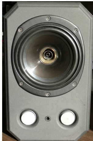
Figure 3.2 – Photographie de l'enceinte Tannoy Sytem 600 avec ses deux événements bouchés.
