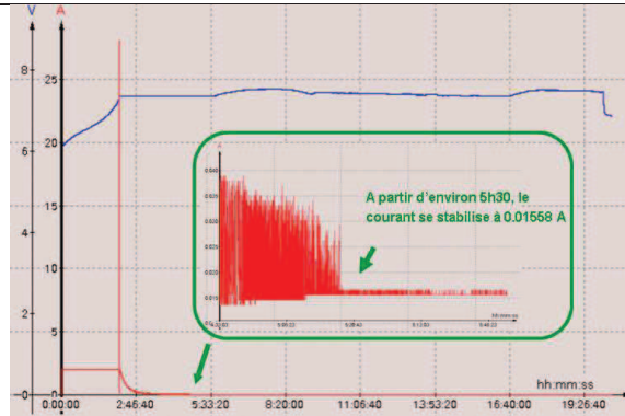
Fig.4. 26 : Résultat expérimental pour un cycle de charge à température ambiante de 25°C
