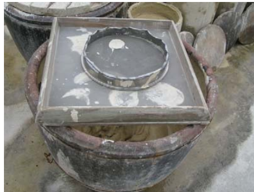
Figure 240 : Tamis utilisés dans le lavage des argiles, Jingdezhen, 11 avril 2009. Photographie : N. Balard.
