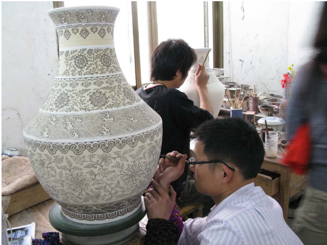
Figure 268 : Peinture sous couverte, Jingdezhen, 11 avril 2009. Photographie : N. Balard.
