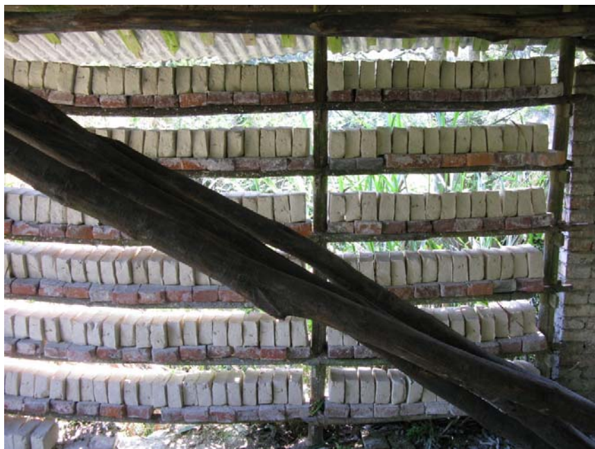
Figure 236 : Briquettes de petuntse , Jingdezhen, 9 avril 2009. Photographie : N. Balard.
