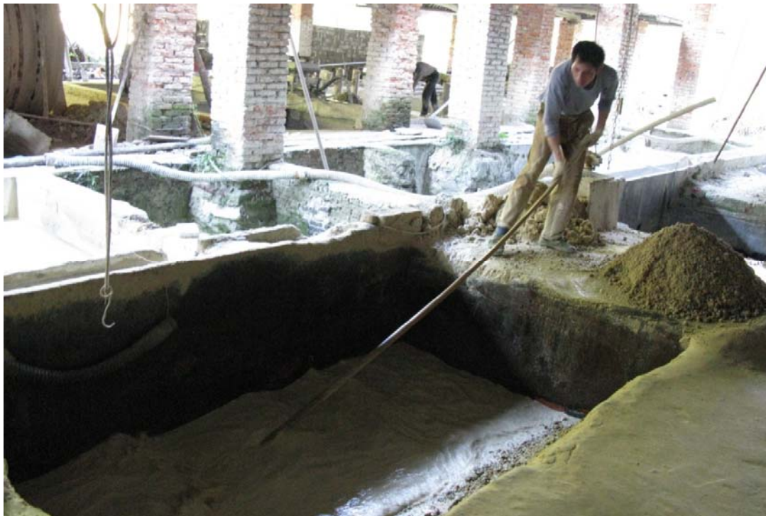
Figure 235 : Le lavage des terres, Jingdezhen, 9 avril 2009. Photographie : N. Balard.
