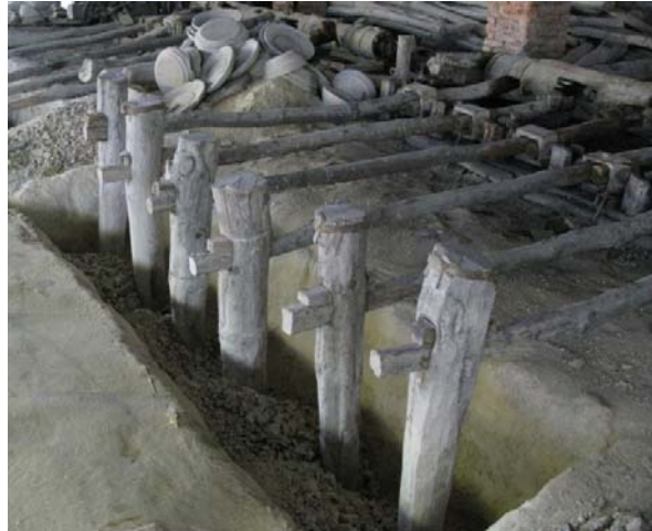
Figure 232 : Pilon à eau traditionnels, Jingdezhen, 9 avril 2009. Photographie : N. Balard.
