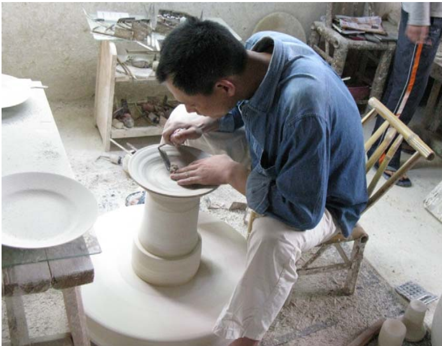
Figure 259 : Le tournassage, Jingdezhen, 11 avril 2009. Photographie : N. Balard.
