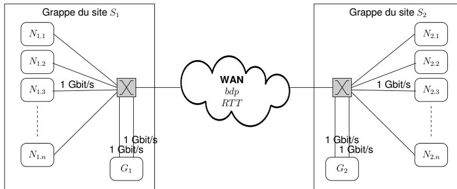
FIG. 3.7 – Banc d'essai générique utilisé dans nos expériences
