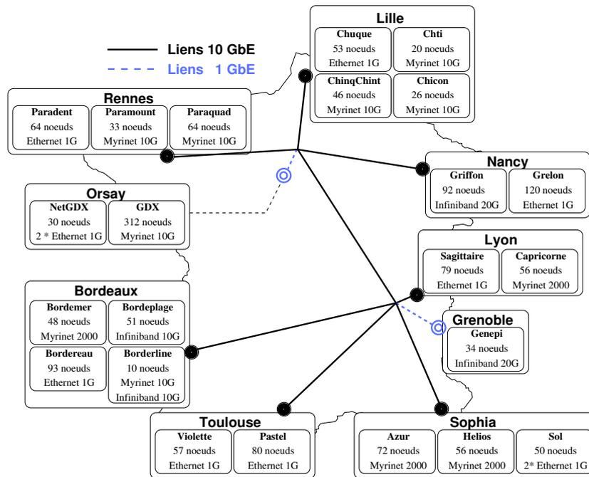
FIG. 1.2 – Interconnexion des grappes de Grid5000
