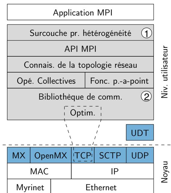
FIG. 2.10 – Interactions des différentes couches lors de l'exécution d'une application MPI
