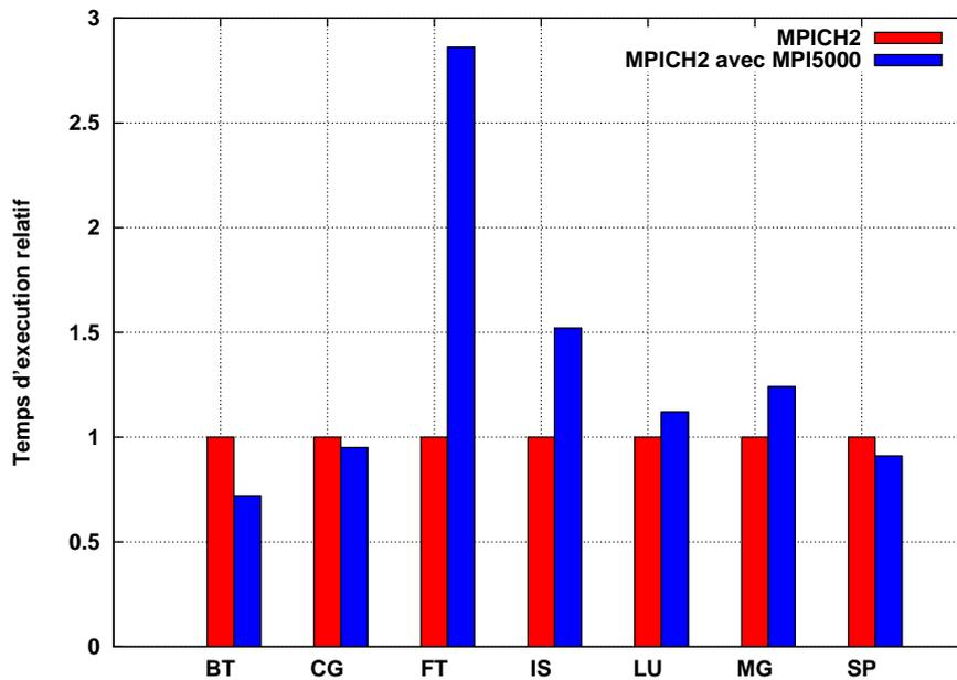
FIG. 5.8 – Temps d’exécution des NPB avec MPI5000 normalisés par MPICH2.
