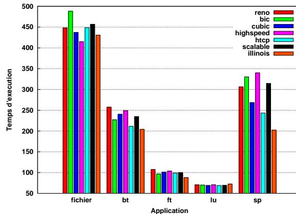
FIG. 4.9 – Exécution d’applications avec différentes variantes de TCP.
