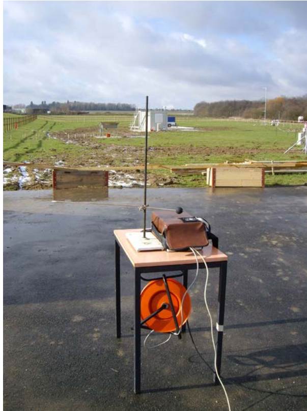
Figure 2.29 : Photo du spectroradiomètre LI-1800 avec un système permettant d'alterner manuellement un rayonnement solaire total et un rayonnement solaire diffus sur le récepteur de l'instrument.
