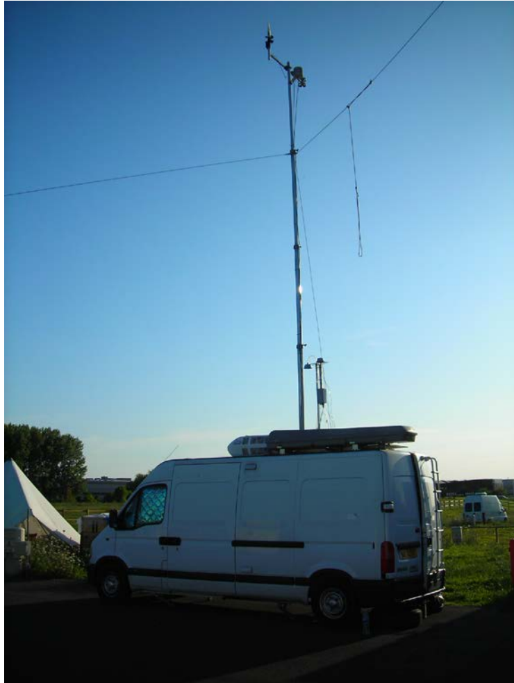
Figure 2.26 : Photo de MILEAGE avec son mat télescopique de 9m.
