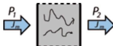
Figure II-17 : Schéma illustrant le flux massique à travers un milieu poreux sous gradient de pression.
