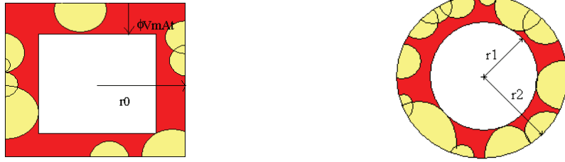
figure 8 Schématisation à l'instant t de deux grains, dont le cœur n'est pas atteint.
