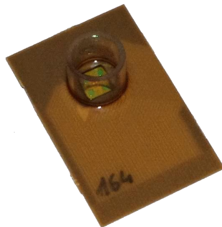
Figure 4.10 : Photo d'une puce montée sur support PCB avec cône de culture
