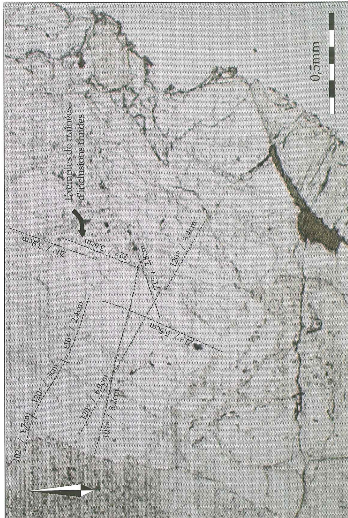
Fig. 37 - Quartz contenant des traînées d'inclusions fluides repérées et mesurées. Le premier chiffre indique la direction, le second la longueur sur l'image.
