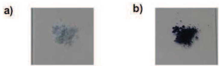
Figure 7-15. Photographie d'une poudre de LQ-1P avant (a) et après (b) exposition à la lumière
