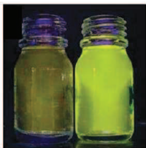
Figure 5-5. Emission de fluorescence d'une solution de chloroalkoxy tétrazine (à gauche) et d'une solution de NITZ (à droite) à la même concentration ( 5 \mu\text{mol.L}^{-1} ) dans le dichlorométhane
