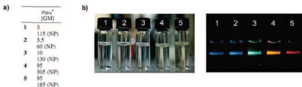
Figure 2-6. (a) Valeurs de sections efficaces d'absorption à deux photons mesurées dans le cyclohexane pour les fluorophores en solution et les nanoparticules ; (b) Clichés des suspensions des nanoparticules étudiées dans l'eau en transmission et sous excitation UV ( \lambda_{exc} = 365 \text{ nm} )
