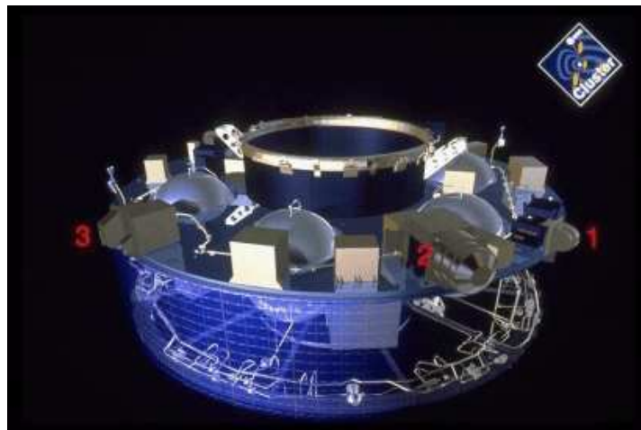
FIG. 2.7 – Représentation d'un des satellites avec position des instruments dédiés à la détection des particules : 1 - PEACE, 2 - CIS, 3 - RAPID (ASE).
