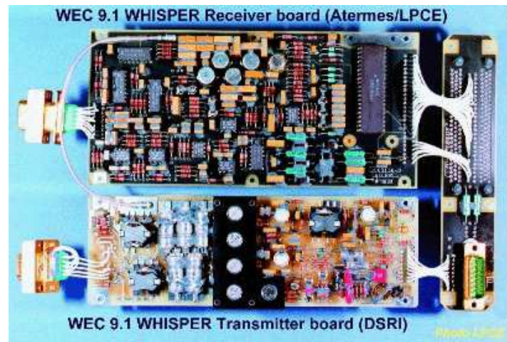
FIG. 2.8 – Electronique du récepteur (en haut) et de l'émetteur (en bas) d'ondes radio constituant le coeur de l'instrument WHISPER (ASE).
