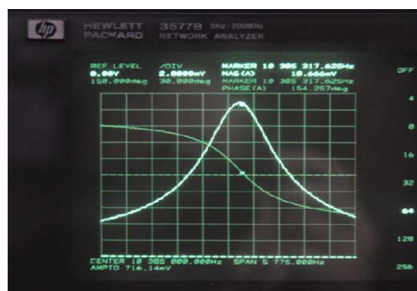
Fig. 5.4 Photo des courbes d'amplitude et de phase de la réponse mécanique enregistrée avec la sonde BMI et l'analyseur de réseau.
