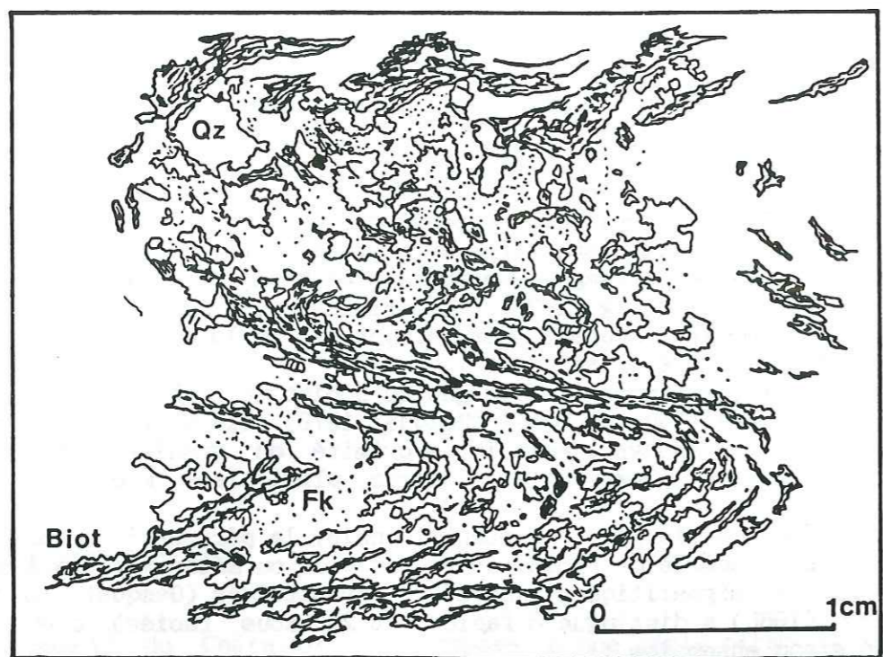
Fig : II-2 gneiss à biotites, (forêt du Sapey). Qz : quartz à extinction roulante; Fk : masse de feldspaths fortement séricitisés; biot : biotites plissées et partiellement chloritisées.
