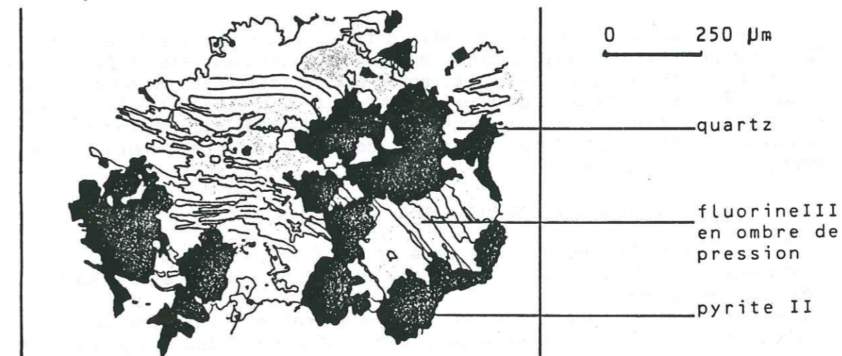
Fig V-55 : fluorine (III) croissant en "ombre de pression" autour de la pyrite au Replat.
