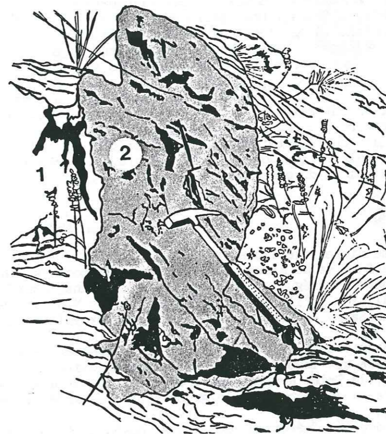
Fig III-41 : bloc de Trias calcaire éboulé (2) dans les schistes domériens (1), sur le flanc sud-ouest du Châtelard.
