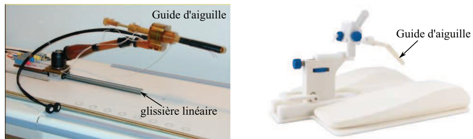
FIGURE 1.5 – À gauche, système de positionnement passif développé par [Krieger 2005]. À droite, Dynatrim, solution passive de positionnement développée par Invivo Corp.
