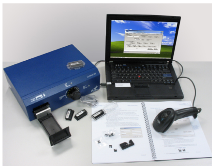
FIGURE 4.7 – Le lecteur microStar pour OSL nanoDot de Landauer et son dispositif informatique.
