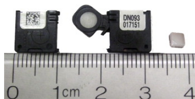
FIGURE 4.6 – Le dosimètre OSL nanoDot de Landauer successivement fermé et ouvert avec la pastille d'alumine sortie.
