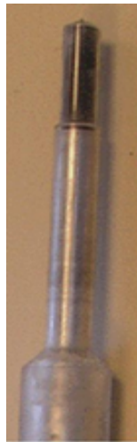
FIGURE 4.2 – Photographie de la chambre d'ionisation NE-2571.
