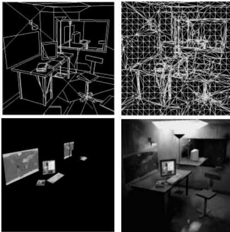
FIG. 6.3 – Données utilisées par la méthode de prévisualisation de Pighin (de haut en bas, et de gauche a droite) : position des bords géométriques, maillage de Delaunay contraint associé, carte des textures sans calcul d'éclairage, image résultat.
