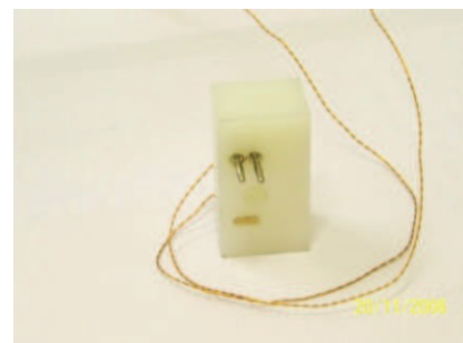
Fig 4.5 : Vue du dispositif permettant de mesurer la tension V pins
