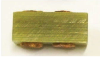
Fig. 4.2 : Vue du sabot du projectile avec les brins constituant les ponts de courant
