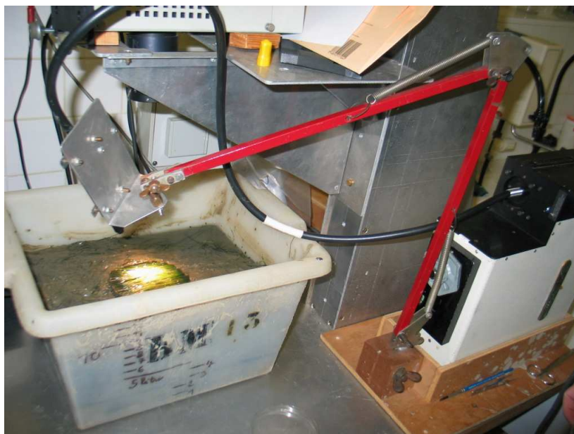
FIGURE 3.2 – Mesures des biomasses de Z. noltii par le spectroradiomètre GER3700. Les herbiers sont disposés de façon à couvrir exactement le champ de vision du spectroradiomètre (photographie N. Harin)
