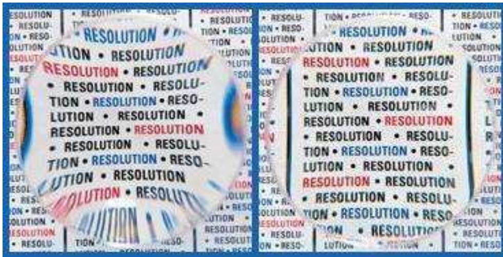
Figure I.1 : comparaison entre l'image déformée d'un texte à travers une lentille sphérique (à gauche) et celle, intacte, obtenue à travers une lentille asphérique (à droite).
