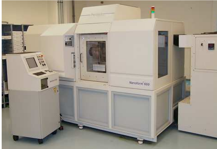
Figure I.7 : tour de très grande précision Nanoform 600 de Precitech pour le tournage à l'outil diamant et la microrectification.
