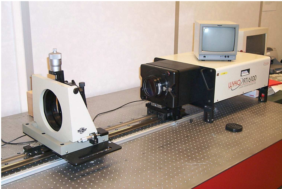
Figure II.10 : banc de mesures de dioptries sphériques par interférométrie [59] .
