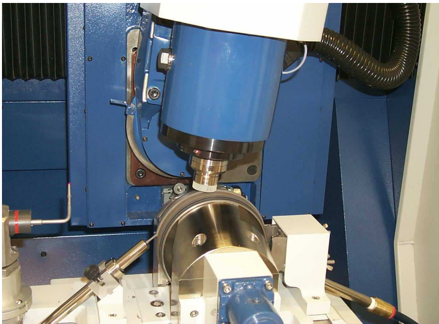
Figure I.16 : zone de travail de la machine Q22 de finition MRF pendant un polissage.
