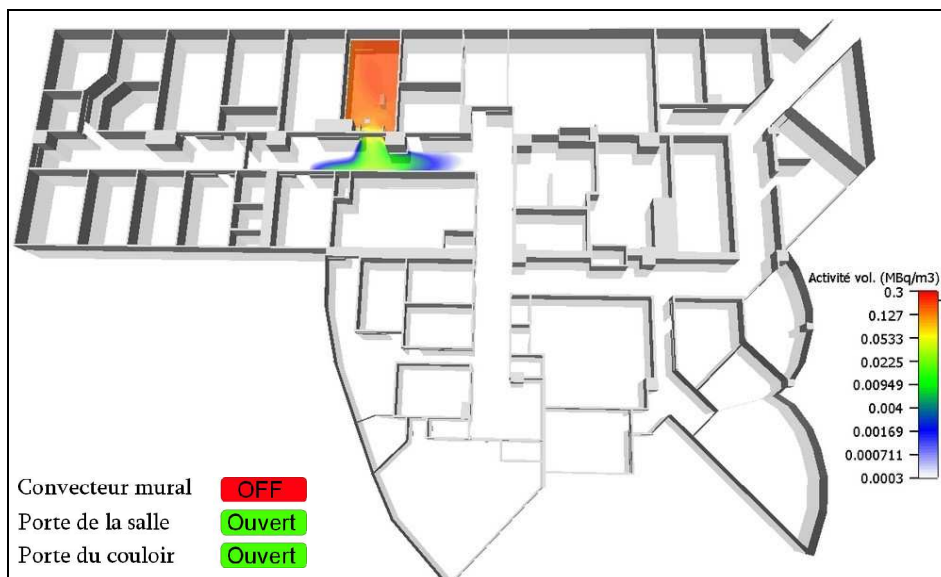
Fig. 5-12 : Après 10 minutes, porte couloir ouverte. (à comparer à la Fig. 5-2)
