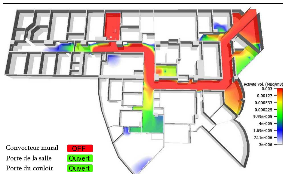
Fig. 5-14 : Après 1 heure, porte couloir ouverte. Echelle /100 (à comparer à la Fig. 5-5)
