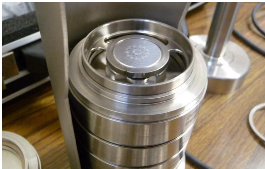
Photo 3-4 : Disque fin d'aluminium graissé placé sur un étage du DLPI.
