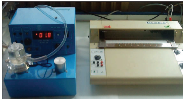
Figure 2.10 : Matériel utilisé lors de l'étude mitochondriale. L'électrode de Clark est à l'intérieur de la cuve thermostatée reliée à une interface électronique (en bleu). Le tracé est recueilli par une table traçante.
