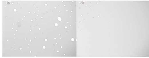
Fig. 2.13 – Problème de dégazage du BCB lors du collage sous vide
