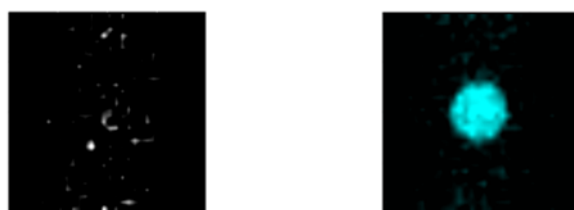
Figure 7-7 : Images axiales ^{129}\text{Xe} d'écho de gradient rapide d'un tube de 8 mm contenant 200 \mu\text{M} de la sonde 1 et 100 \mu\text{M} d'ions \text{Ca}^{2+} . A gauche, la solution utilisée pour réaliser l'image ne contient pas d'ions \text{Zn}^{2+} . A droite, des ions \text{Zn}^{2+} ont été ajoutés avec une concentration de 100 \mu\text{M} . Les images ont été acquises avec une impulsion sélective centrée sur le déplacement chimique de 67,20 ppm, en 16 scans et avec un TR de 25 ms. L'acquisition de chaque image a pris 13 secondes (32 points et 781 \mu\text{m} par pixel dans chaque dimension).
