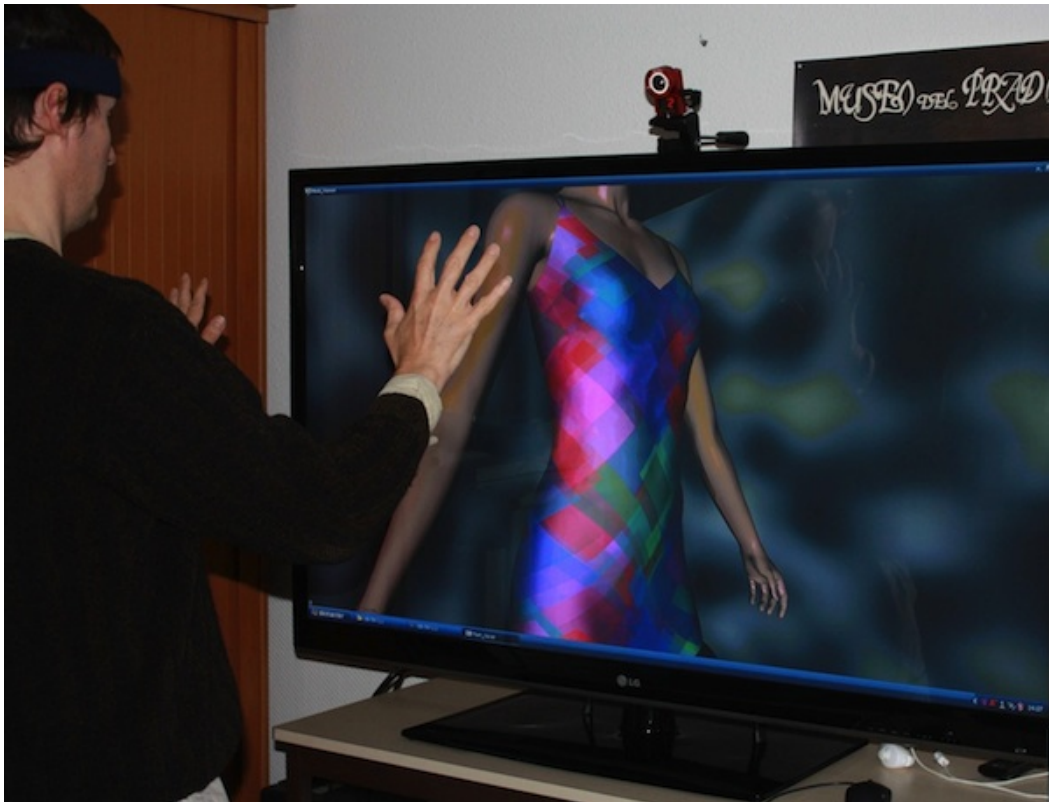
FIGURE 5.12 – Interface homme-machine permettant l'application de motifs décoratifs sur un mannequin virtuel. Les actions se font par la détection automatique des mouvements des doigts de l'utilisateur capturés via la caméra infrarouge fixée en haut de l'écran.
