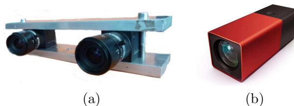
Fig. 3: (a) Exemple de système stéréoscopique (b) Caméra plénoptique développée par Lytro.
