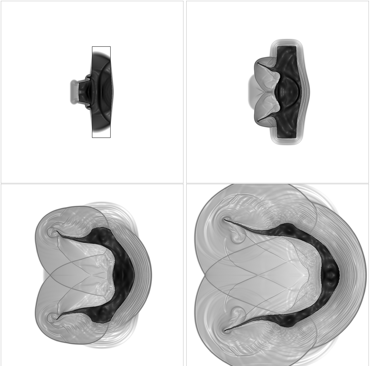
Figure IV.19 – Images Schlieren à t = 0.38, 1.4, 4.2, 7.1 \cdot 10^{-4} s pour l'impact avec \chi_3 .
